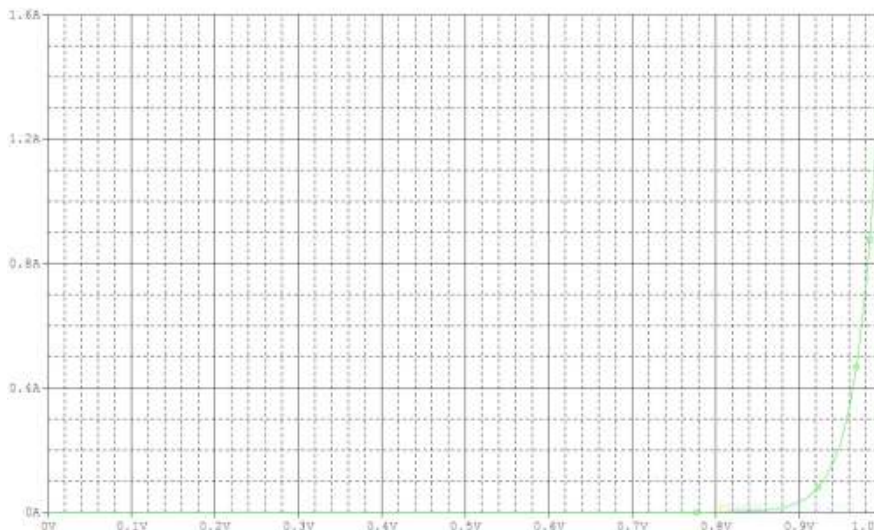
Abb.: Eingangskennlinie im Bereich 0-1V
