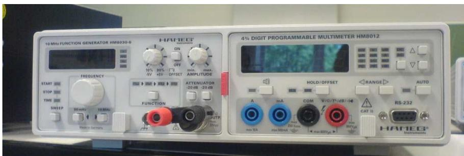
Abb. 2: Gehäuse, indem ein Funktionsgenerator (linke Seite) und ein Multimeter (rechte Seite) eingebaut sind
