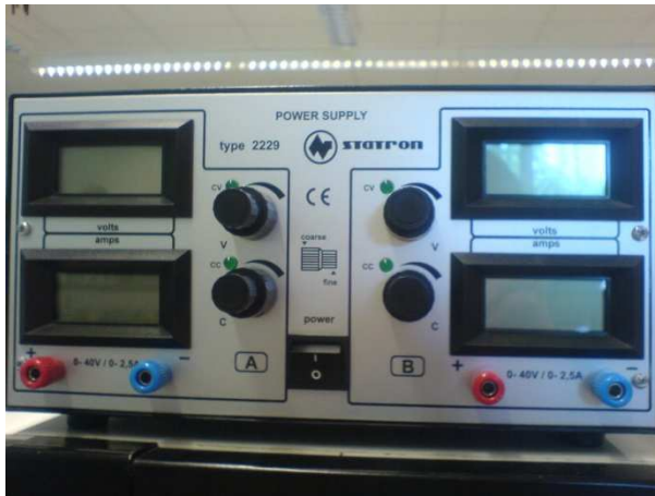
Abb. 1: Spannungsquelle zur Versorgung der Schaltungen
