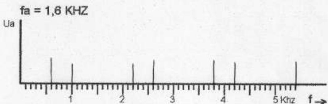
Bei einer Abtastfrequenz von 16 KHz und 8 KHz liegen die Seitenbänder mit  $\pm 1 \text{ KHz}$  (abzutastende Frequenz) um den „Träger“ (Abtastfrequenz) herum und kommen vor allem dem Originalsignal „nicht in die Quere“. Bei 1,6 KHz überschneiden sich die Seitenbänder und spiegeln auch ins Basisband und verursachen Verzerrungen. Dies wird mit Aufgabe 5 anschaulich wiedergegeben.
